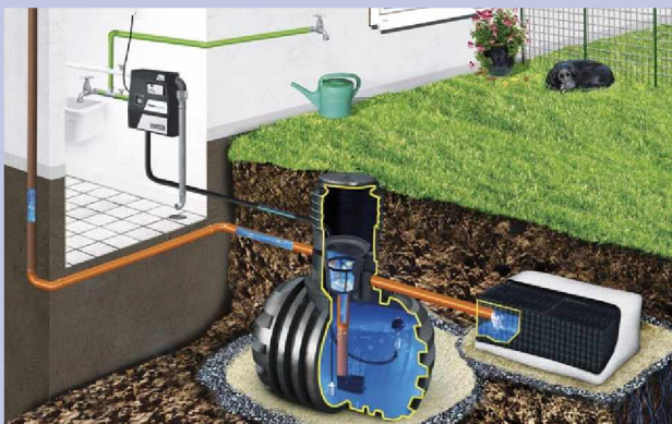
System podziemny domowo-ogrodowy z odprowadzeniem nadmiaru deszczówki do systemu rozsączającego
